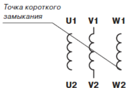
Рис. 16. Моделирование короткого замыкания фазных обмоток W2 и V1
