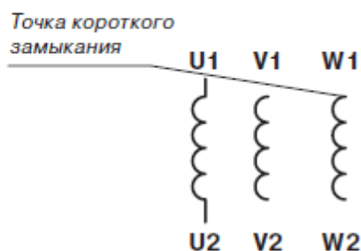
Рис. 19. Моделирование короткого замыкания фазных обмоток U1 и V2
