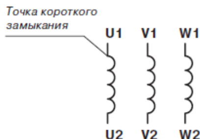
Рис. 18. Моделирование короткого замыкания фазной обмотки U
