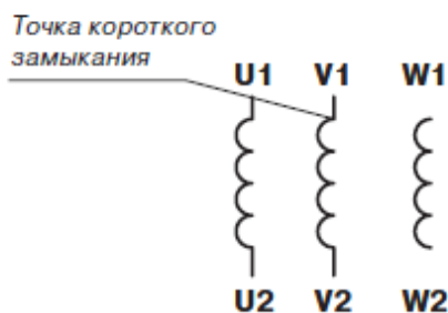
Рис. 15. Моделирование короткого замыкания фазных обмоток V1 и V2
